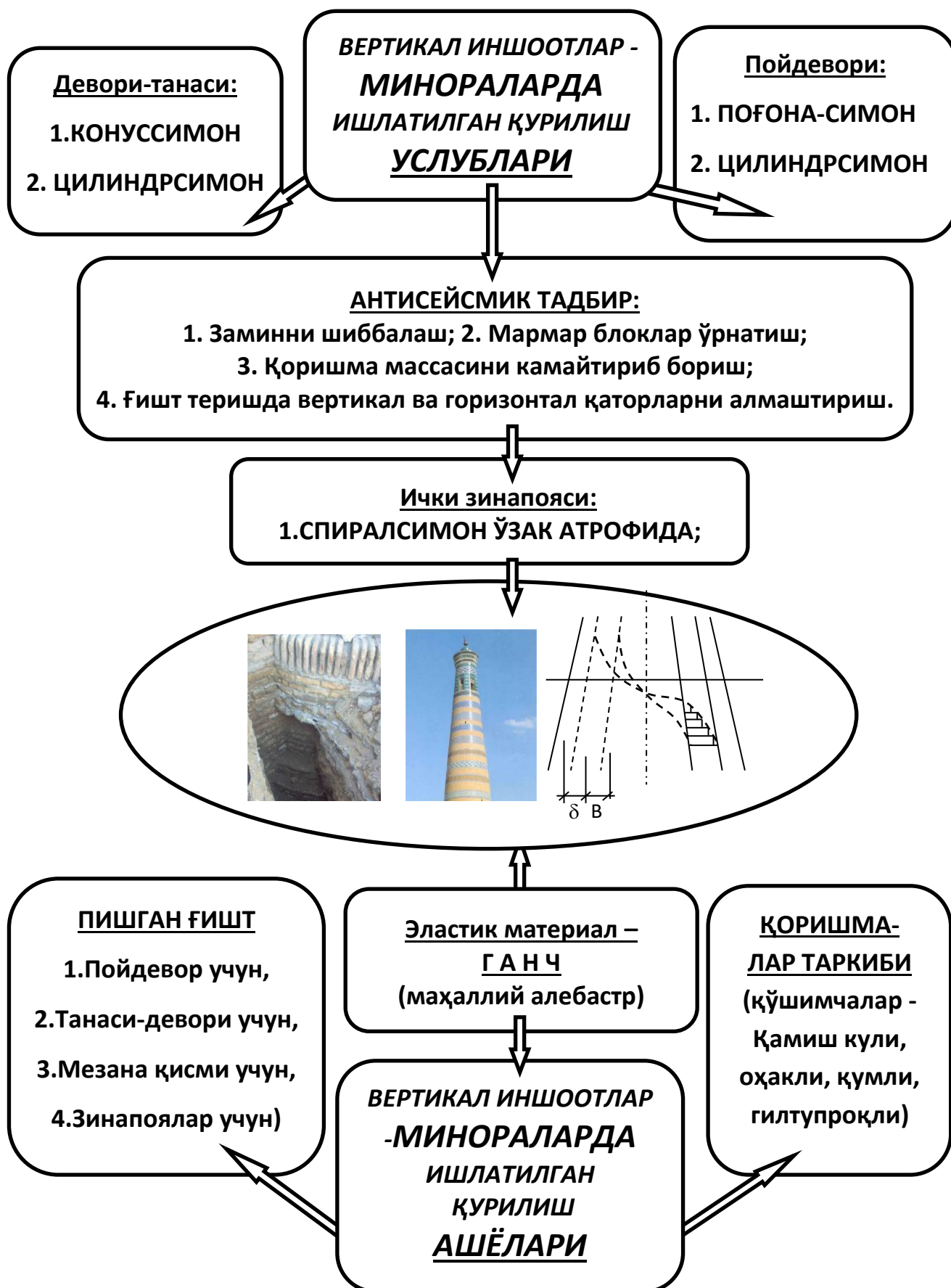
Илова. Тарихий вертикал иншоотлар – минораларда қўлланилган услублар ва ашёларнинг ишлатилиш схемаси
