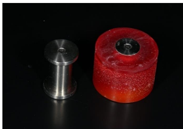
Рис. 4. Переходник для фиксации и установки образца пломбы на прибор UltraTester (Ultradent, USA)
