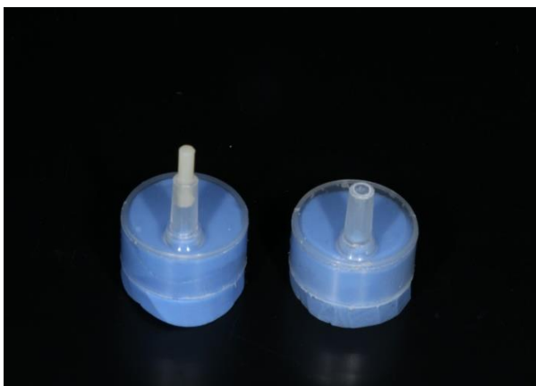
Рис. 3. Пластиковая форма для изготовления образцов пломб стандартизированной конфигурации.
