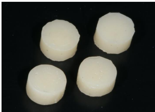
Рис. 10. Образцы пломб из FiltekP60 для определения поверхностной микротвердости материала.
