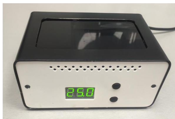
Рис. 6. Устройство для нагрева композитного пломбировочного материала
