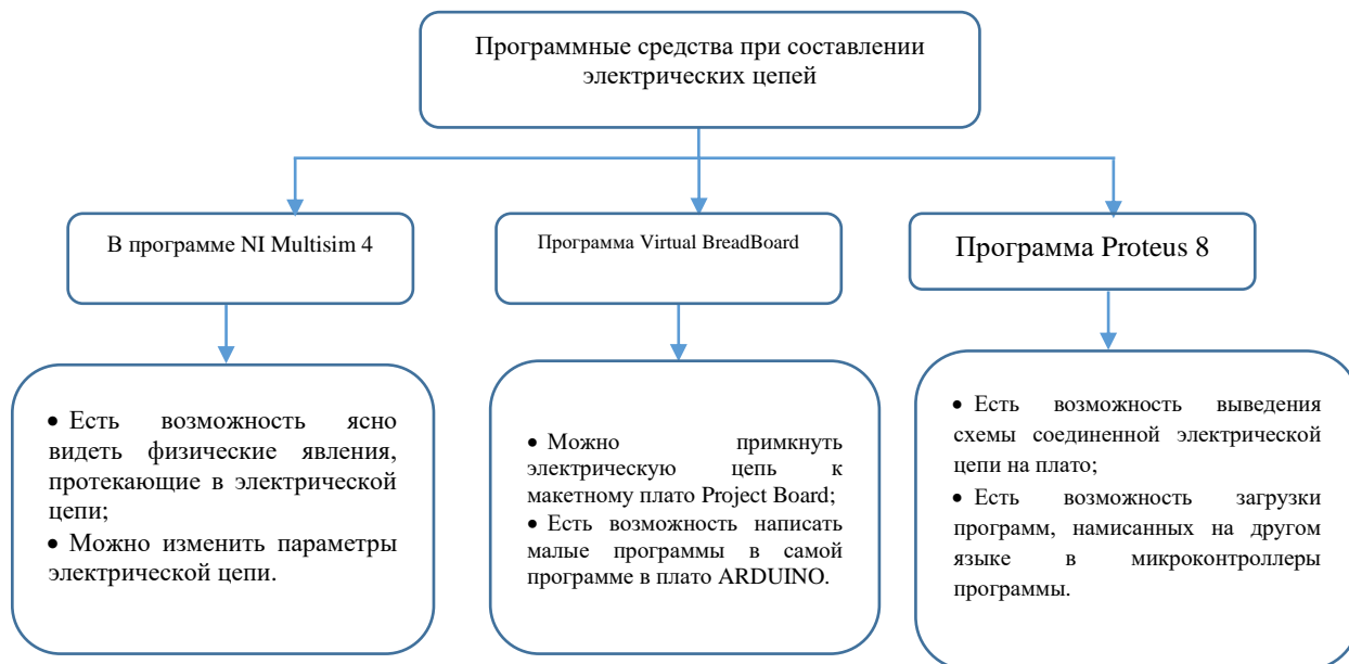
Рис 2. Фрейм-схема “Изучения электрической цепи” при помощи программных средств
