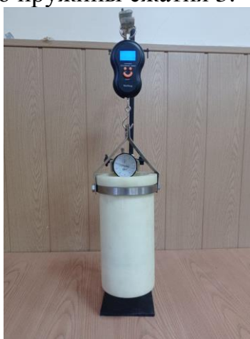
Рис. 3. Прибор для определения модуля упругости \mu и коэффициента Пуассона E минеральных порошков.
