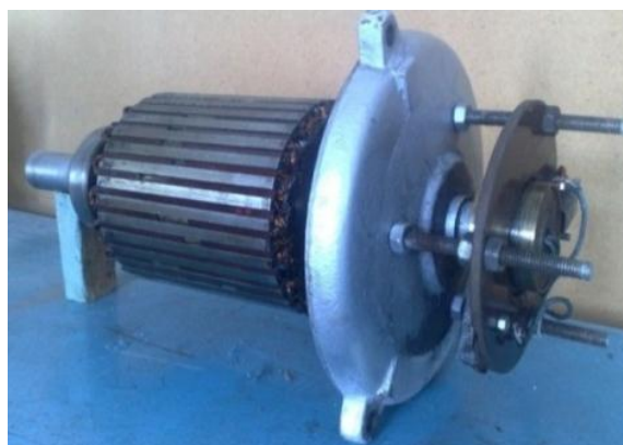
7 – расм. Кўзғатиш ўрамини таъминлайдиган чўтка механизмли генераторнинг ротори
