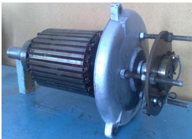
Рис. 7. Ротор генератора с щеточным механизмом питания обмотки возбуждения
