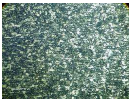
Рис.4. Микроструктура образца наплавленного с порошковыми композиционными материалами ПГ-ФБХ-6-2 (50%)+ПГ-СР4 (50%) (x500)
