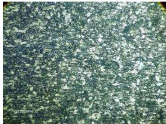
4-расм. ПГ-ФБХ-6-2 (50%)+ПГ-СР4 (50%) кукунлари пайвандлаб қопланган намунанинг микро-структураси (x500)
