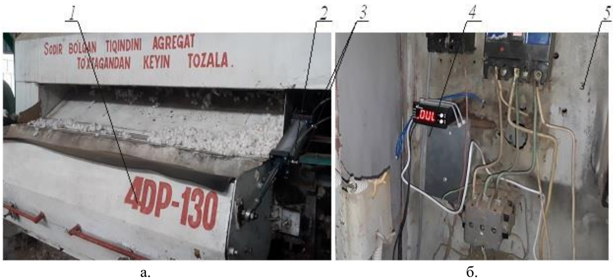
1-ишчи камера, 2-пневмоцилиндр, 3-ҳаво қувири, 4-контроллер, 5-аррали жиннинг электр қутиси, а – ишчи камеранинг ишчи ҳолатдан чиқиш жараёни, б – контроллер кўрсаткичи
