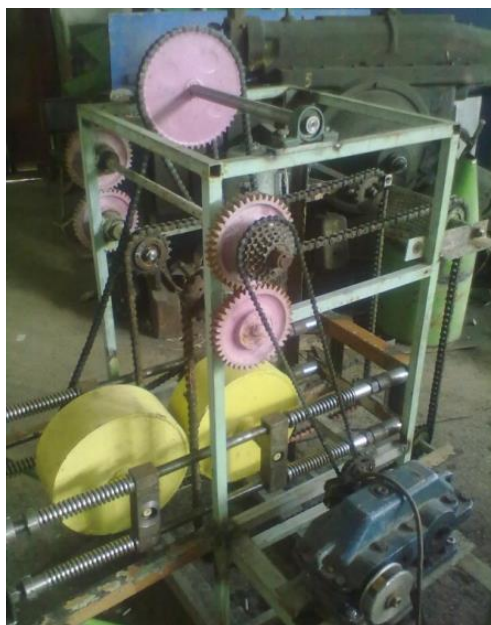
12-расм. Хўл тери хом ашёсини суюқлигини сиқиб олиш учун валикли экспериментал стенд (ЎЗР ФА МИСМИ)
