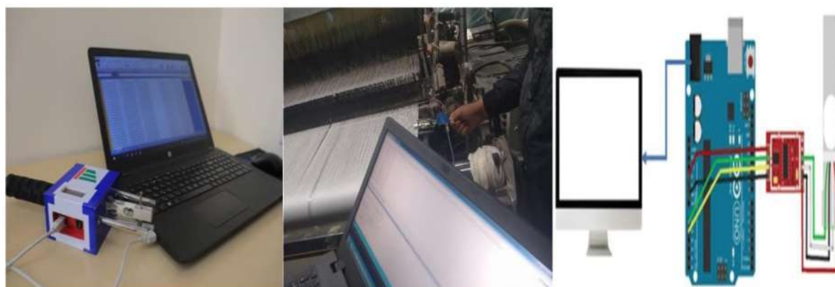
9-расм. Тўқув дастгоҳларида танда иплар таранглигини махсус дастур асосида электрон ўлчовчи мослама ва уни схемаси
