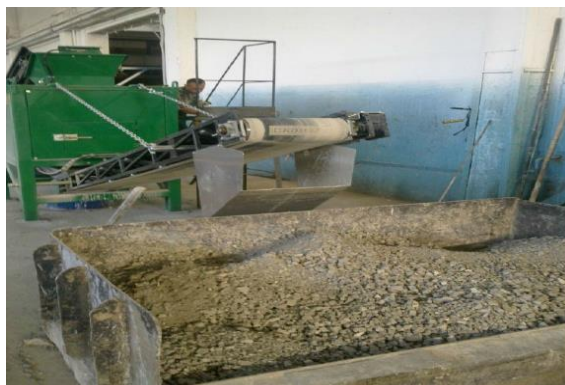
Рис.10. Щековая дробилка ООО “BINOKOR TEMIR BETON SERVIS”
