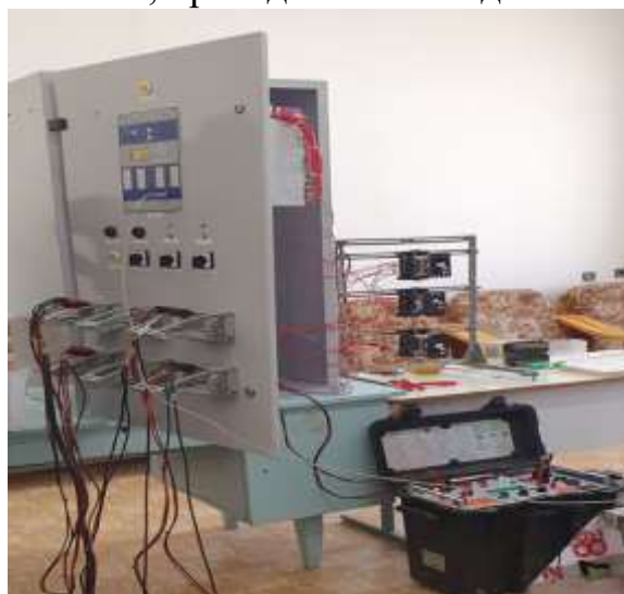
Рис.2 .Физическая имитационная модель (а) и структурная схема (б) устройства БАПР.
