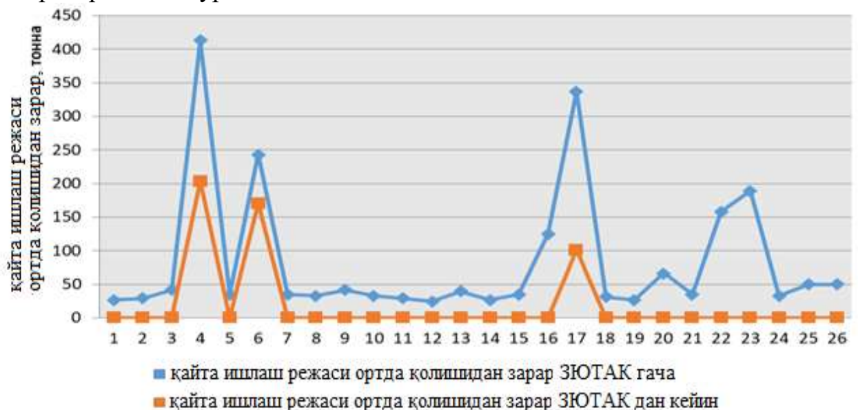
9-расм. 4-ГМЗ 6кВ кучланишли марказий тақсимлаш пунктида Тез ишловчи заҳирани автоматик улаш ишга туширилгунга қадар (2020) ва ишга туширилгандан кейин (2021) рудани қайта ишлаш режасидан орқада қолиш натижаларининг қиёсий графиги.
