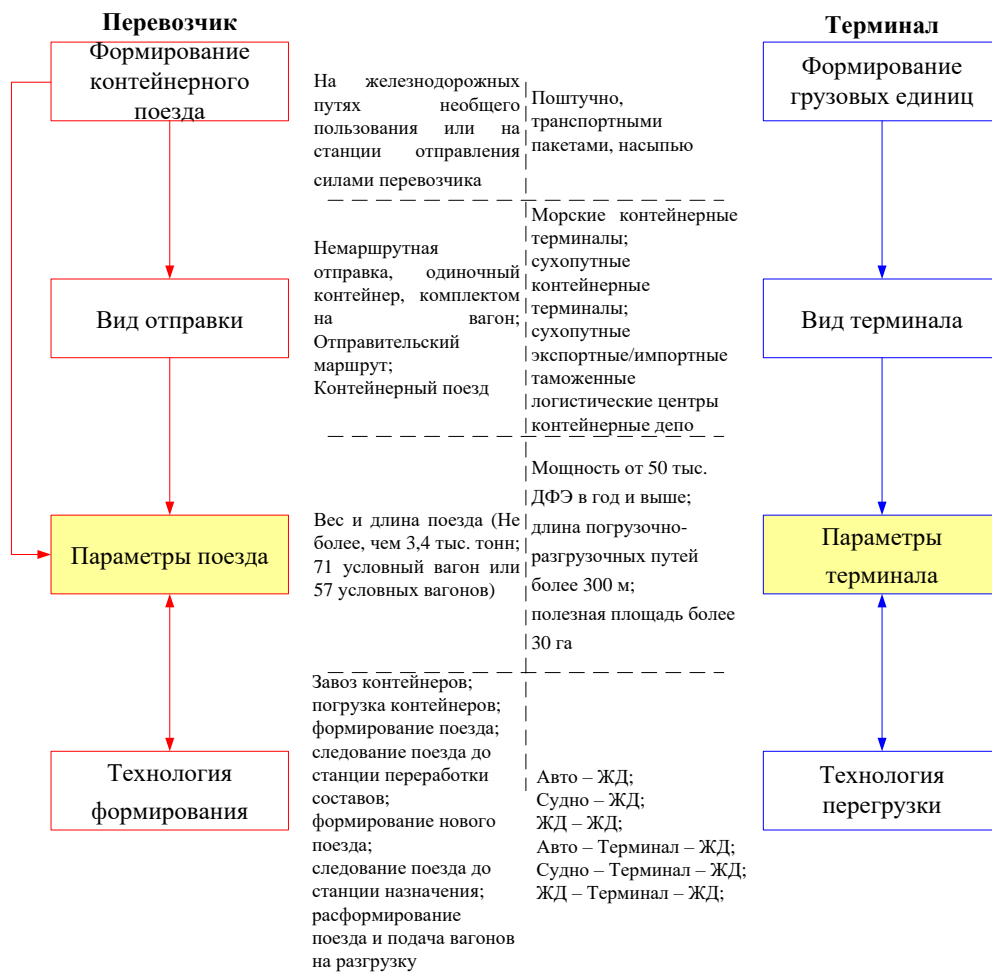
Рис. 4. Факторы, влияющие на организацию контейнерных блок-поездов
