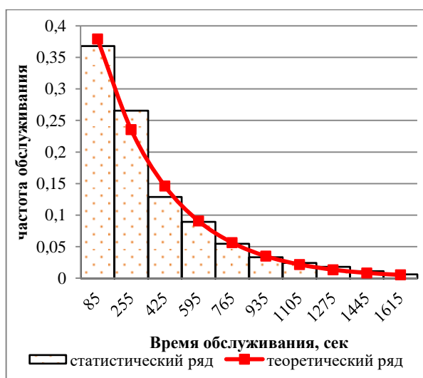
Рис. 7. Гистограмма и гипотетическая кривая плотности показательного распределения при \tau=357 сек
