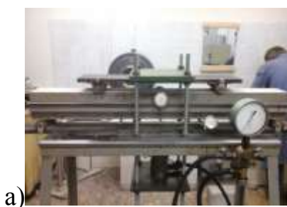
6-расм. Тажриба намуналарининг синовлар ўтқизилгунга қадар ва синов ўтқизилгандан кейинги ҳолатлари (а ва б), расмда бузувчи юкнинг тажрибада ва назарий қийматларини таққослаш (в) диаграммаси кўрсатилган.
