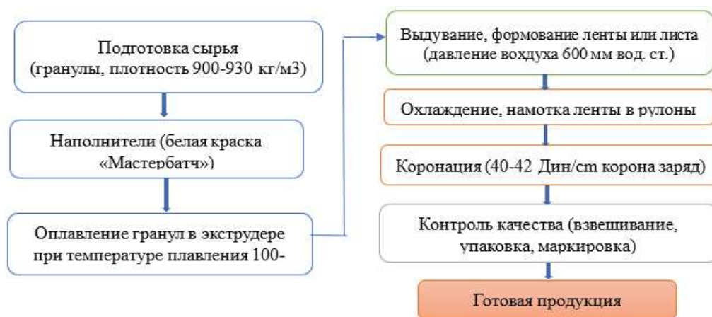
Рис.1. Технологическая схема получения пленки из местного сырья
