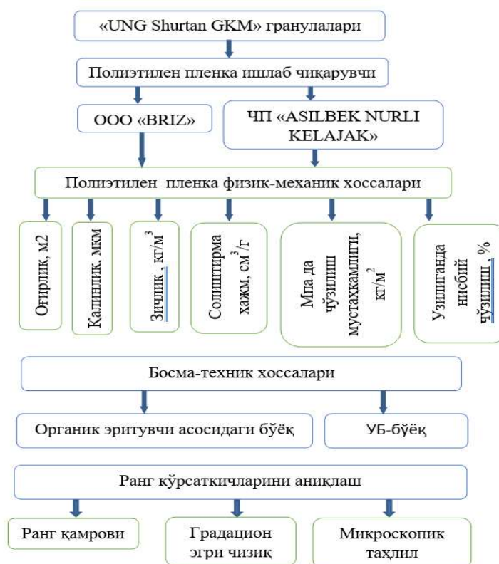
2-расм. Экструзия параметрларининг плёнканинг хоссалари ва босма сифатига таъсири боғлиқлигини баҳолаш учун иерархик структура схемаси
