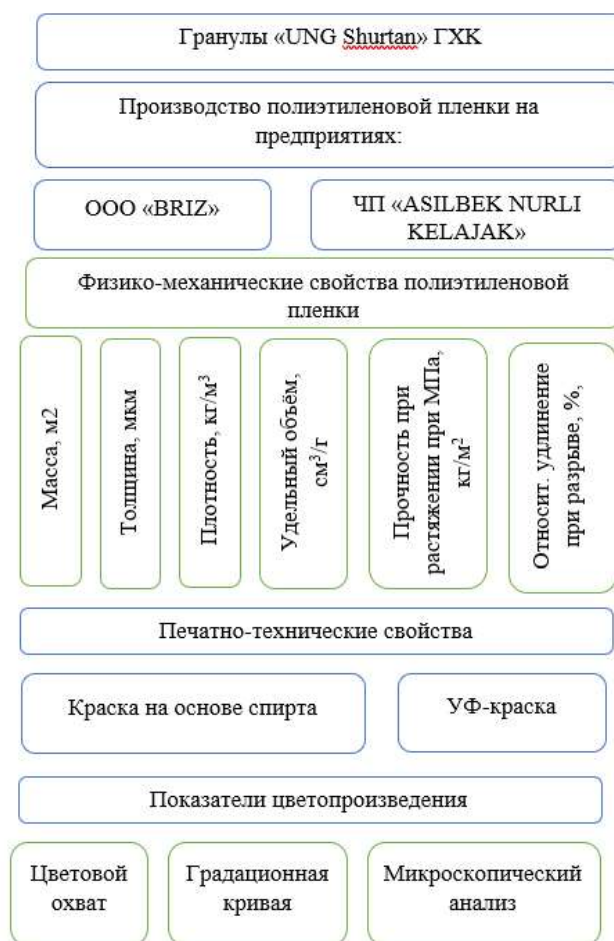
Рис.2. Иерархическая структурная схема для выявления зависимости влияния параметров экструзии на свойства пленки и качество печати
