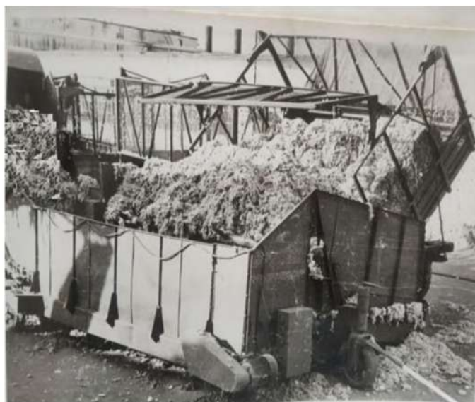
11- расм. Такомиллаштирилган ХПП-III русумли пахтани қабул қилиш-узатиш қурилмаси иш жараёнида
