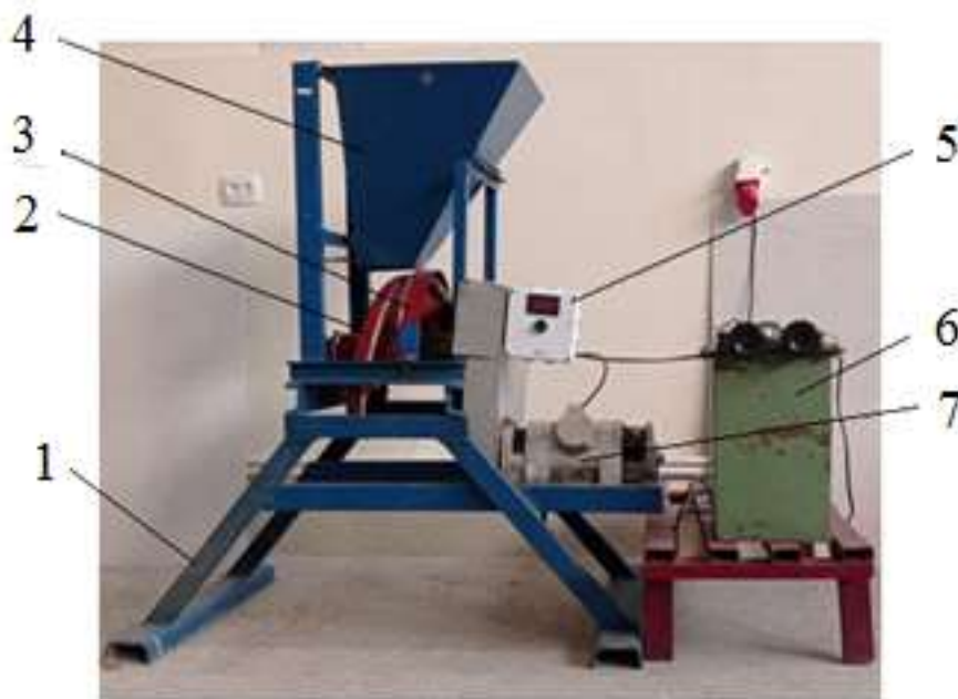
1-рама; 2-винтсимон пичоқ; 3-қўзғалмас пичоғи; 4-бункер; 5- ток ва кучланиш ўлчагич; 6-латр; 7-электродвигатель
