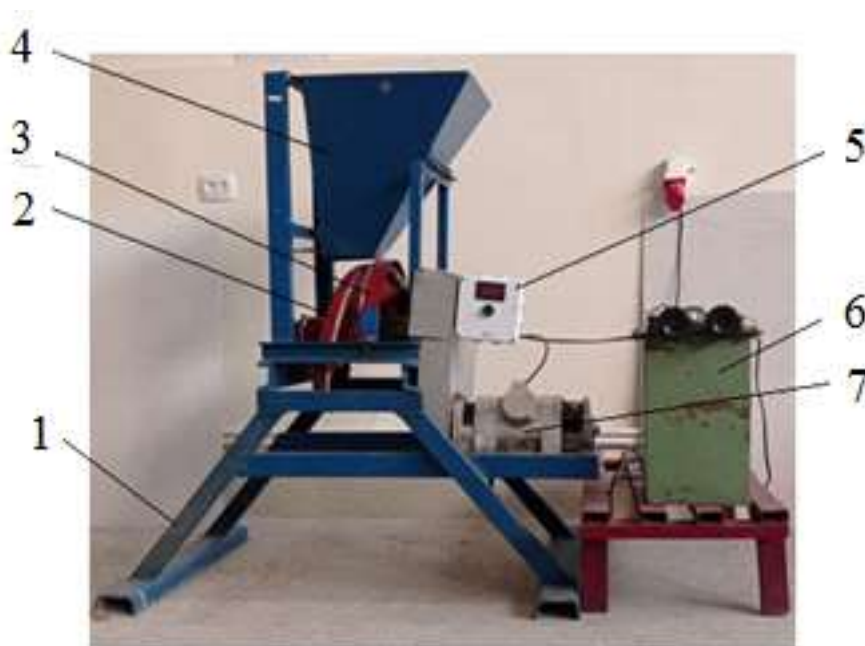
1-рама; 2-винтообразный нож; 3-неподвижный нож; 4-бункер; 5-измеритель тока и напряжения; 6-латр; 7-электродвигатель
