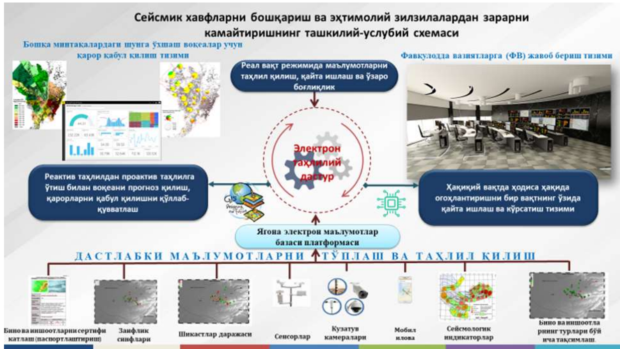
6-расм. ГИС платформасида сейсмик хавфларни бошқариш ва эҳтимолий зилзилалар натижасида етказилган зарарни камайтиришнинг ташкилий-услубий схемаси
