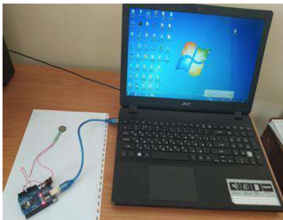
8-расм. ARDIUNO маркали зарба кучини ўлчовчи прибор
