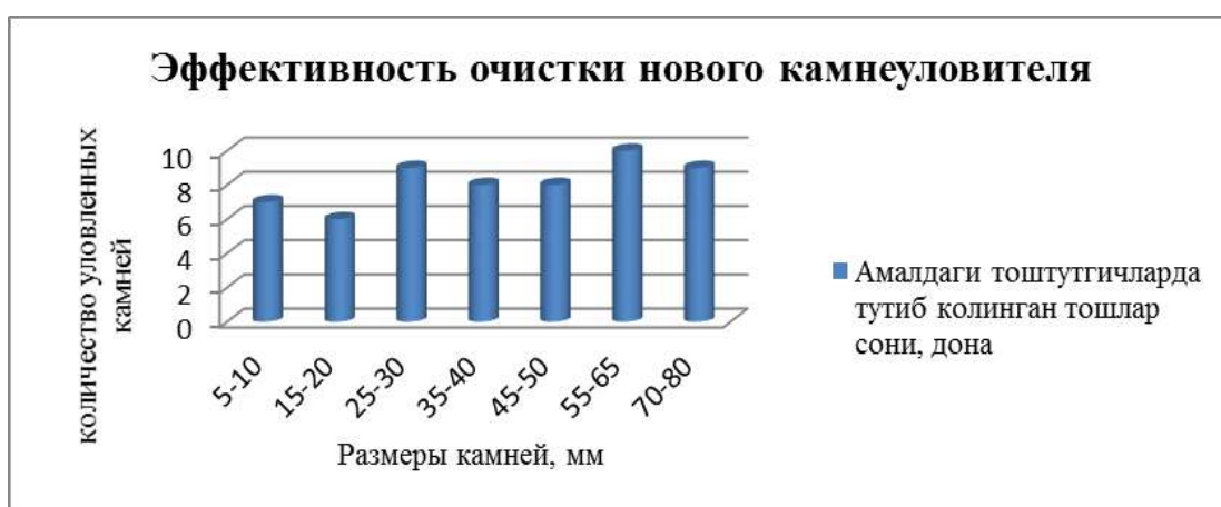
Рисунок 10. График эффективности очистки тяжелых смесей по фракциям в усовершенствованном камнеуловителе
