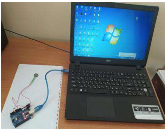
Рисунок 8. Измеритель силы удара ARDIUNO
