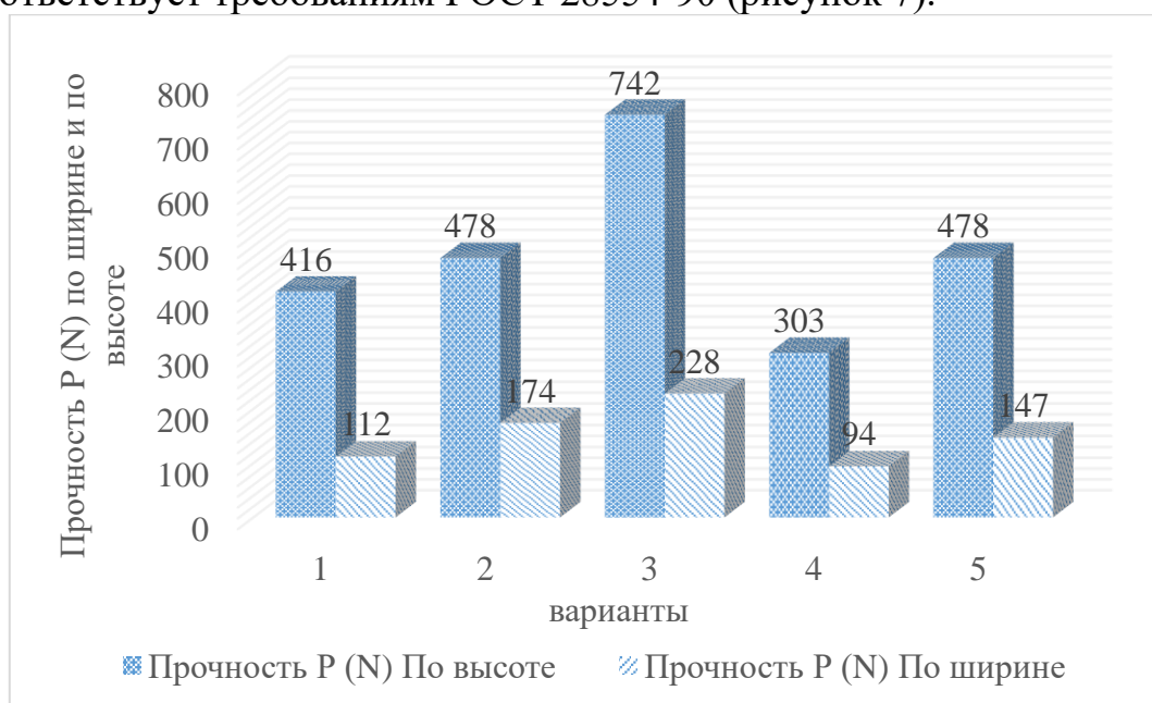
Рисунок 7. Гистограмма изменения прочности на разрыв трикотажных полотен, полученных из разного сырья.
