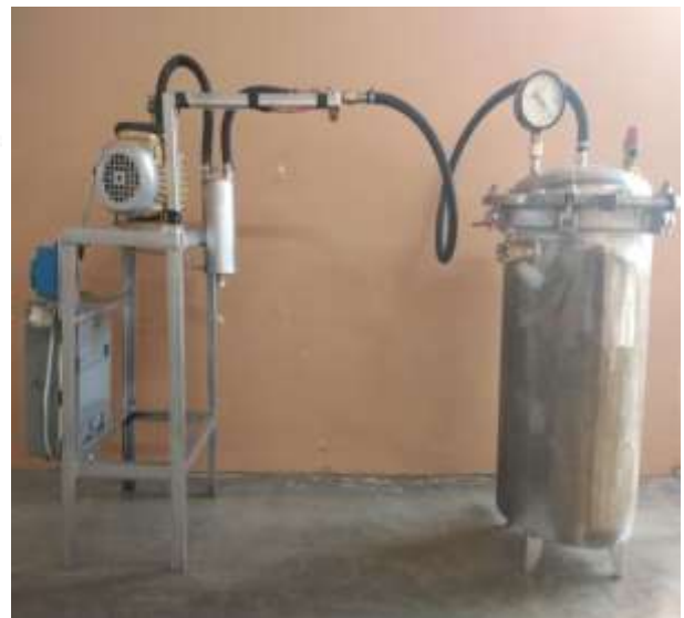
Рис.10. Общий вид вакуум аппарата для увлажнения шелка-сырца.
