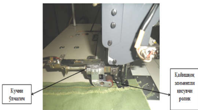
9-расм. Полимер қопламасини суртувчи ускунаси ўрнатилган тикув машинасида параметрларни ўлчашнинг электротензометрик схемаси (а), унинг умумий кўриниши (б) ва қайишқоқ элементли сиқувчи роликни ўрнатилган ҳолати (в) келтирилган.
