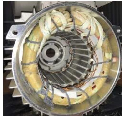
16-расм. Статор пазларида уч фазали уч чулғамли ток ўзгарткичи жойлашган асинхрон мотор статор қисмини кўриниши
