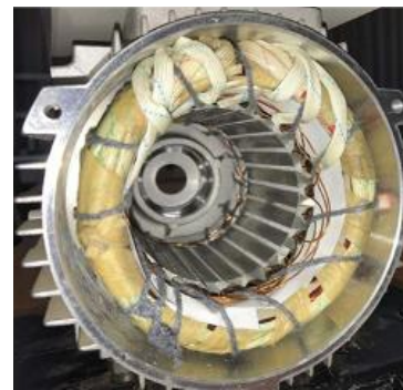
Рис. 16. Вид статорной части асинхронного двигателя, на статорных пазах которого расположен трёхфазный трёхобмоточный преобразователь тока
