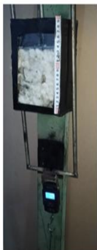
1- рама; 2 – идиш; 3 – плита; 4 – пахта; 5 - плитани ҳаракатга келтурувчи узатма; 6- ўлчагич; 7 – динамометр; 8,9 – шарнирлар; 10 – дастак; 11 – асос
