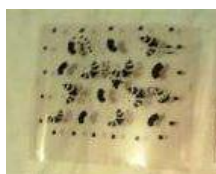
2-расм. Декорнинг ҳар бир ранги учун тайёрланган плёнка формалари (фильм)
