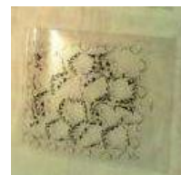
2-расм. Декорнинг ҳар бир ранги учун тайёрланган плёнка формалари (фильм)
