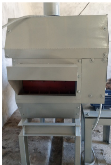
11-рис. Экспериментальный образец разрыхлительной машины для шерсти
