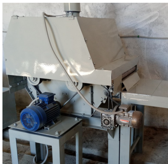
11-расм. Жунни титиш машинасининг тажриба нусхаси.
