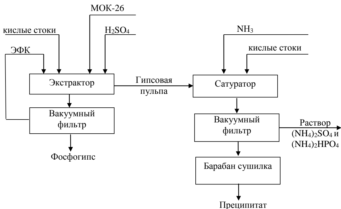
Рис. 4 – Принципиальная технологическая схема производства преципитата и жидкого азотного удобрения.
