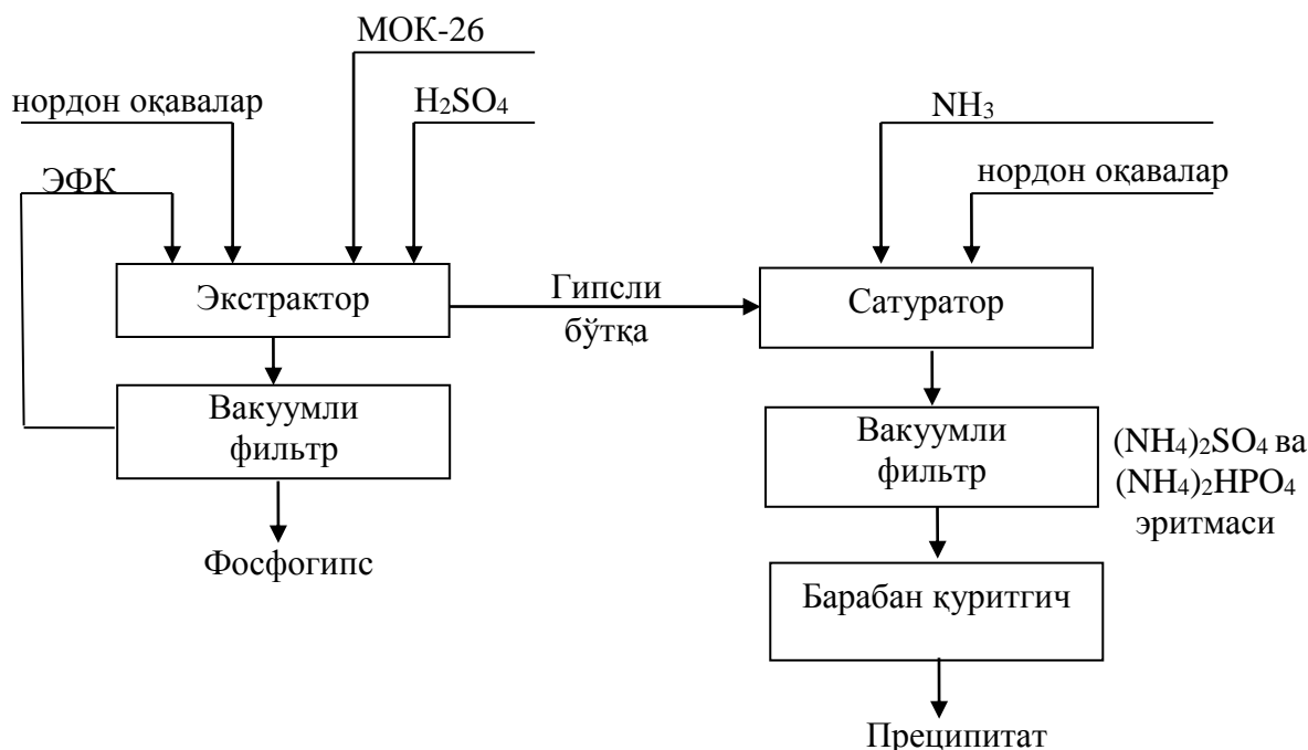
4-расм – Преципитат ва суюқ азотли ўғит ишлаб чиқаришнинг принципиал технологик тизими.
