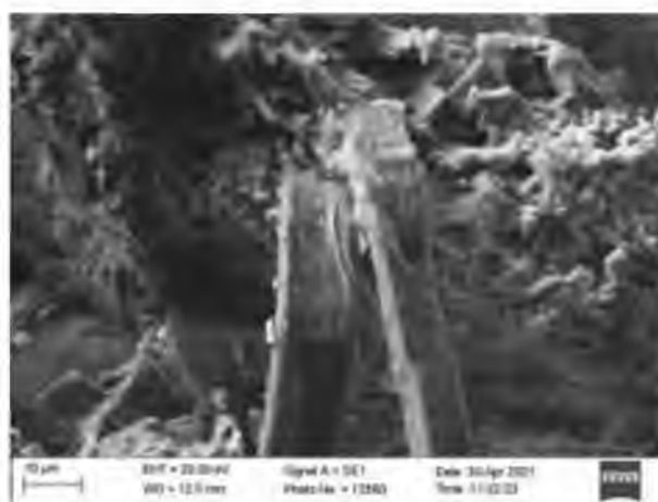
Рисунок 10. Часть волокон, выступающих из гипсового камня
