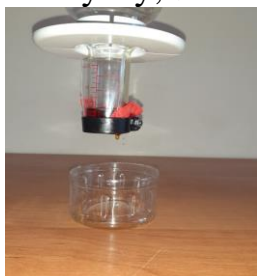
Рис.5. Впитывание и утечка дизельного топлива из 100% хлопчатобумажной ткани.
