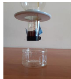
Рис.7. Впитывание и утечка дизельного топлива со смесевой ткани состоящего из 60% хлопка, 40% рогоза
