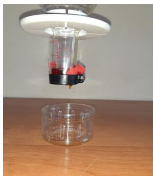
5-расм. 100% пахта толали тўқимадан дизел ёғини шимиши ва оқиб тушиши.
