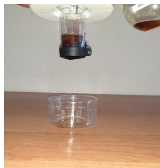
6-расм. 70% пахта, 30% рогоз, толали тўқимадан дизел ёғини шимиши ва оқиб тушиши.
