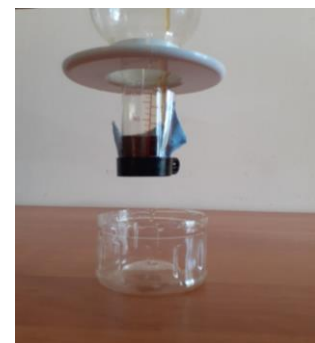
7-расм. 60% пахта, 40% рогоз толали тўқимадан дизел ёғини шимиши ва оқиб тушиши.
