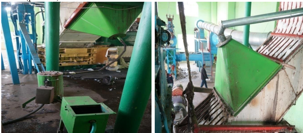
Рис.12. Монтаж оборудования для увлажнения волокна В производственных условиях эксперименты проводились на режимах, приведенных в таблице 4
