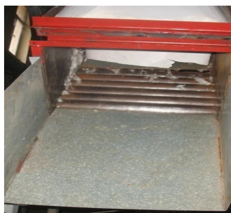
8-расм. Толани намлаш ускунасининг ён томондан (чапда) ва олд томондан (ўнгда) кўриниши
