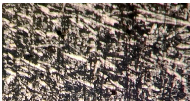
1.10-расм.Қолип остига советгич сифатида қалинлиги 50мм бўлган Бронза БРО5Ц5C5плита жойлаштирилгандаги микроструктурада карбидлар советгич қўйилган томонга тик жойлашган.
