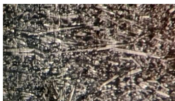
Рис.1.6 Карбиды размещаются перпендикулярно стороне холодильника в микроструктуре, когда алюминиевая пластина АК9 толщиной 50 мм помещается под форму в качестве холодильника..
