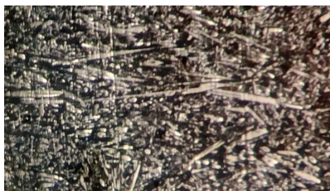
1.6-расм. Қолип остига совитгич сифатида қалинлиги 50мм бўлган Алюминий АК9 плита жойлаштирилгандаги микроструктурада карбидлар совитгич қўйилган томонга тик жойлашган.
