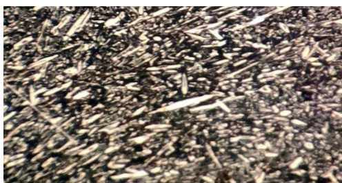
Рис.1.8. В микроструктуре, где медная пластина Cu 99.9 толщиной 50 мм размещена в качестве охладителя под кристаллизатором, карбиды расположены перпендикулярно стороне, на которой установлен холодильник..
