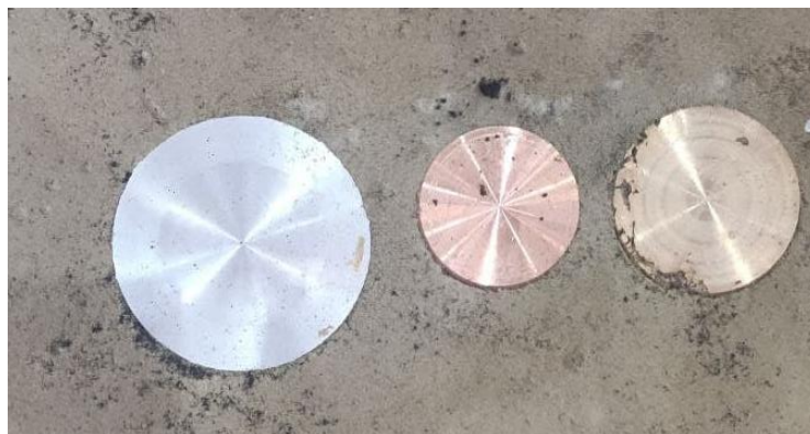
1.5-расм. 3 совитгич: асосида қалинлиги 50мм Алюминий АК9 бўлган совитгич билан, асосида қалинлиги 50 мм мис Cu 99.9 бўлган совитгич билан, асосида қалинлиги 50мм Бронза БРО5Ц5С5 бўлган совитгич билан.
