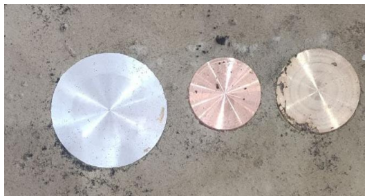
Рис.1.5. 3 холодильника: с холодильником толщиной 50 мм Алюминий АК9, с холодильником толщиной 50 мм Медь Cu 99.9, с холодильником толщиной 50 мм Бронза БРО5Ц5С5.
