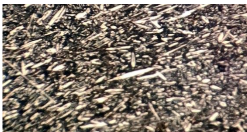
1.8-расм.Қолип остига советгич сифатида қалинлиги 50мм бўлган Мис Cu 99.9 плита жойлаштирилгандаги микроструктурада карбидлар советгич қўйилган томонга тик жойлашган.
