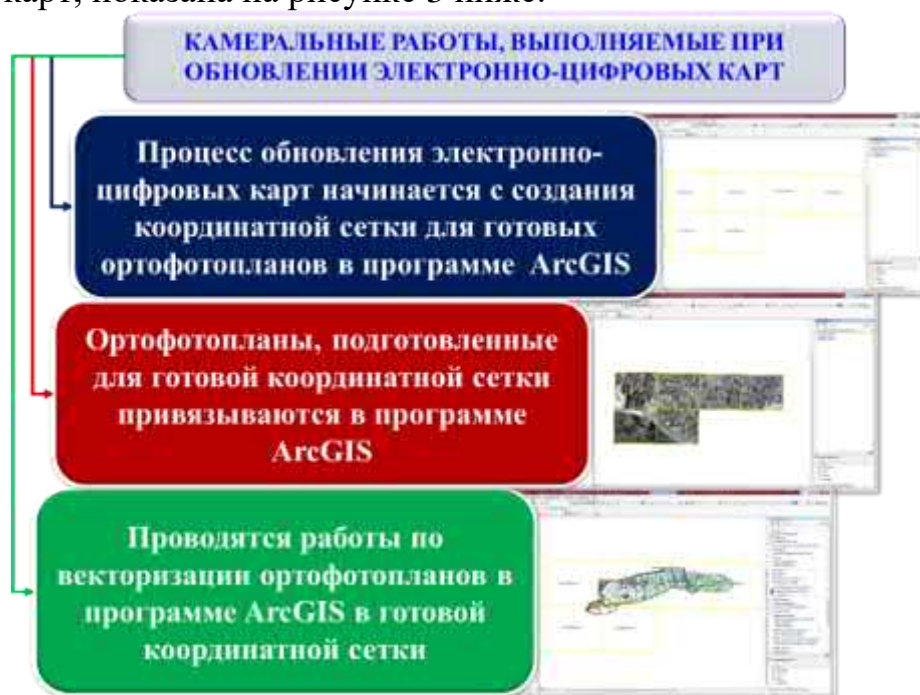
Рис. 3. Порядок камеральных работ при обновлении электронных цифровых карт
