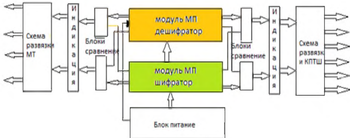
Рис. 4. Функциональная схема интегрированного микроэлектронного формирователя импульсов.
