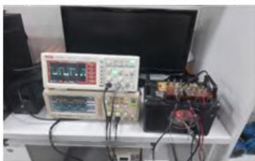
8-расм. Бирлаштирилган микроэлектрон импульс шакллантиргични осциллографлар ёрдамида текширишларини ўтказиш
