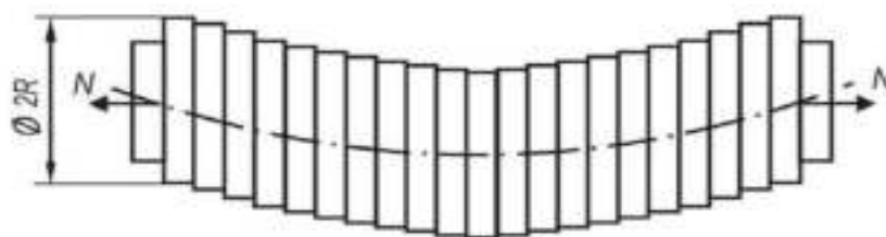
Рис. 4 Работа пакета плоских элементов при отсутствии усилия сжатия.
