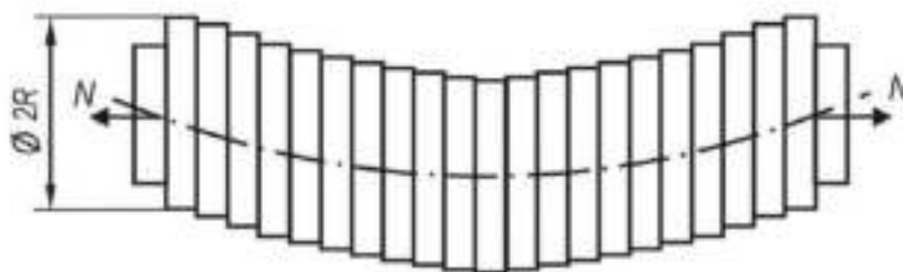
4 - расмда Сиқувчи кучланиш бўлмаганда ясси дисксимон элементлар пакетининг ишлаши
