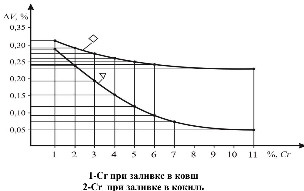
Рис. 3. График зависимости добавления хрома в ковш и кокиль для на степень воздействия хрома на износостойкость белого чугуна.
