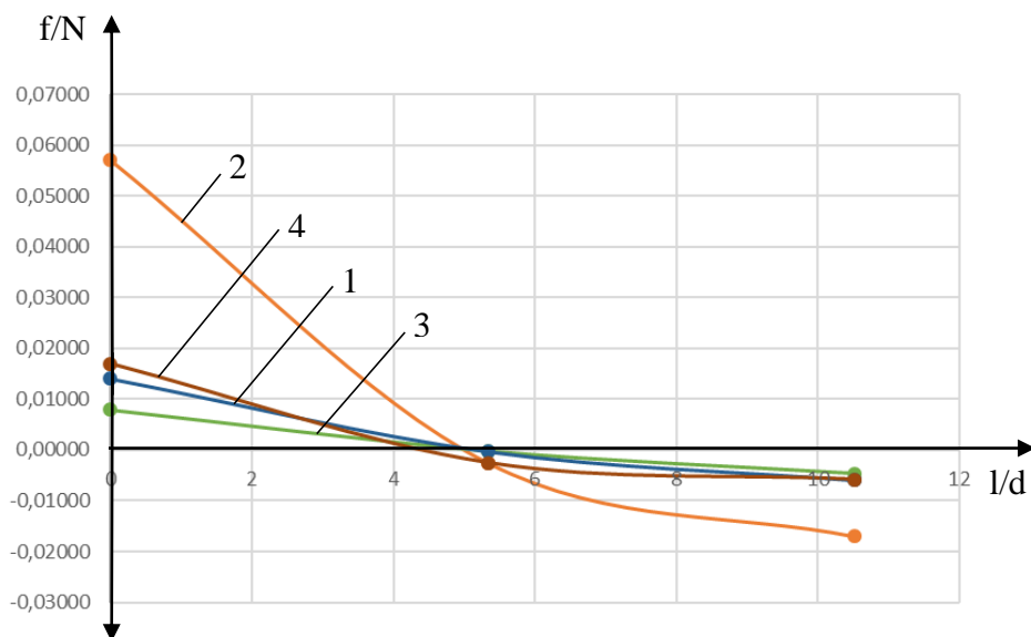
Рис. 3. График прогиба единичной нагрузки ( f/N ), от приведенного расстояния ( 1/d ), где d - диаметр жесткой круглой штамп, через которую передавалась сила. 1-на естественном основании; 2- на водонасещенном основании; 3- на естественном основании укрепленном с модели ВАЭ; 4- на водонасещенном основании укрепленном с модели ВАЭ.
