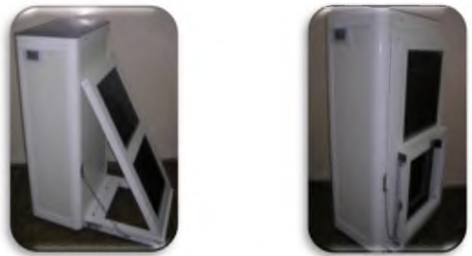
Рис.24. Общий вид опытного образца опреснительной установки с солнечным фотоэлектрическим преобразователем 7
