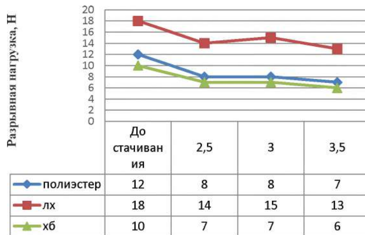
Рис.4. Зависимость разрывной нагрузки от длины стежка
