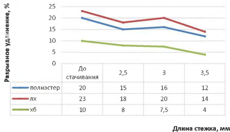
Рис.5. Зависимость разрывного удлинения от длины стежка
