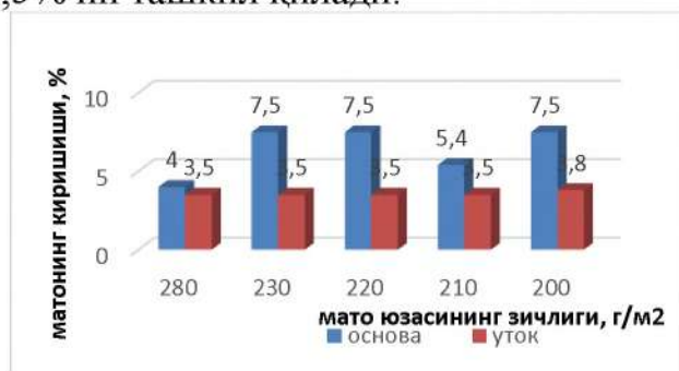
1-расм. Мавжуд пахта толали газламаларининг танда ва арқоқ бўйича киришиши
