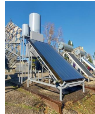
Рис. 10. Автоматизированный теплогидравлический испытательный стенд:
