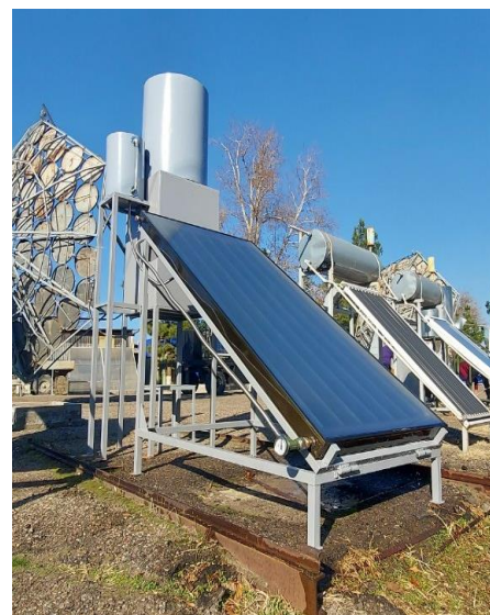
10-расм. Автоматлаштирилган иссиқлик гидравлик синов стенди:
