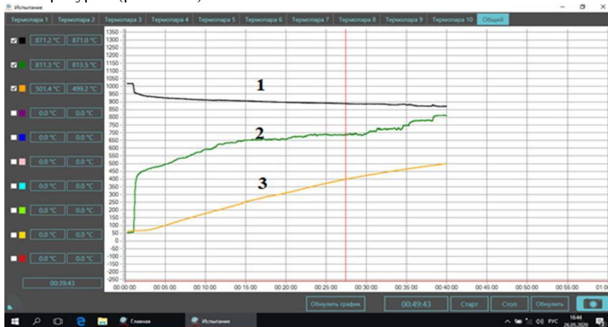
Рис. 4. Вывод результатов измерений от термопар в графический режим программного обеспечения MCTR – 1000: 1-температура внутри печи; 2-температура перед образцом; 3-температура за образцом
