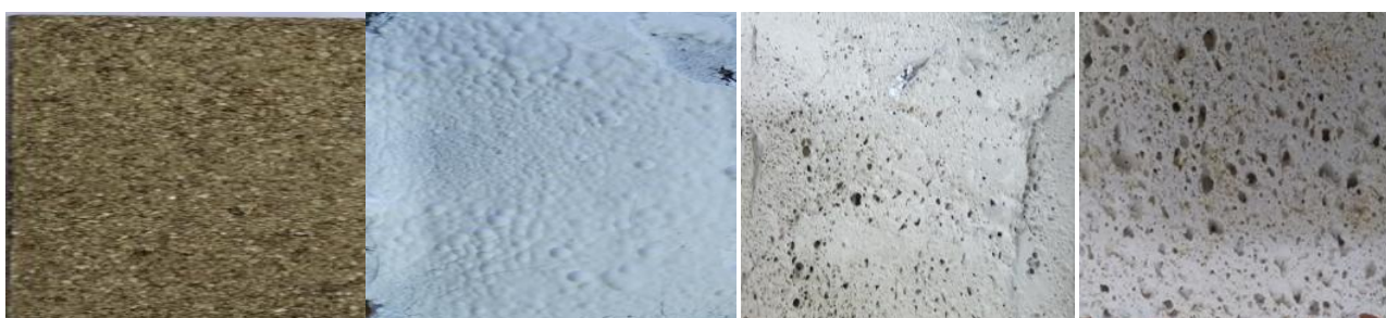
Рис. 6. Плитка вермикулитовая до (слева) и после (справа) испытаний
