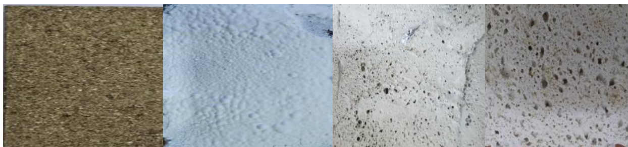
6-расм. Вермикулитли плитка синовгача (чапда) ва синовдан кейин (ўнгда)
