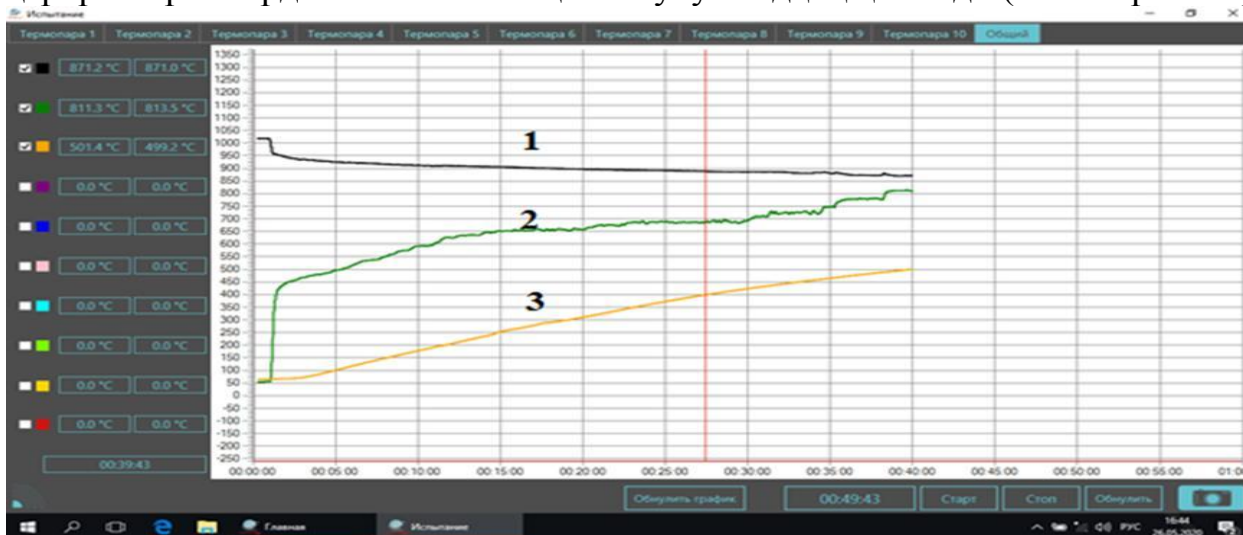
4-расм. MCTR – 1000 дастурий таъминотдаги график режимида термопарадан ўлчов натижаларининг таҳлили: 1-печ ичидаги ҳарорат; 2- намуна олдидаги ҳарорат; 3-намунанинг ортидаги ҳарорат.
