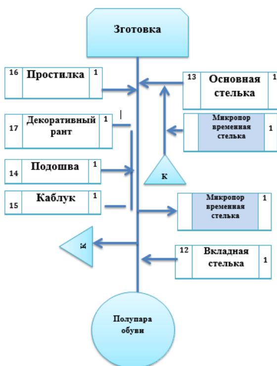
Рис.10. Схема сборки обуви
