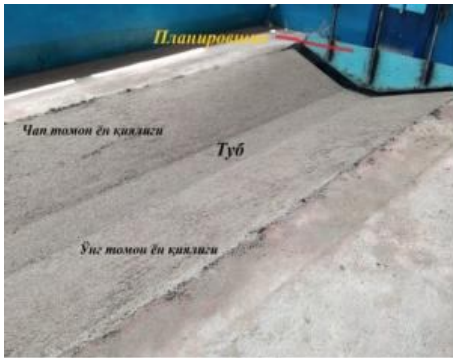
Рис.2. Модель грунтового канала несвязного грунта
