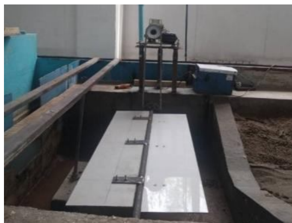
3-rasm. Aylanuvchi plastinka turidagi to‘lqin hosil qiluvchi moslama sxemasi
