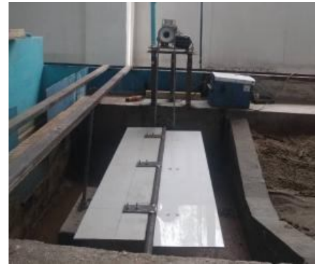
Рис.3. Переносной волнопродуктор типа вращающего щита.
