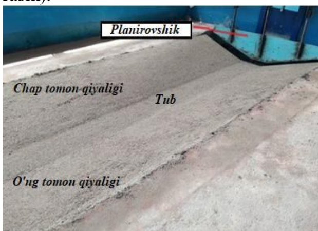
2-rasm. Bog‘lanmagan gruntli trapesiya shaklidagi kanalning modeli.
