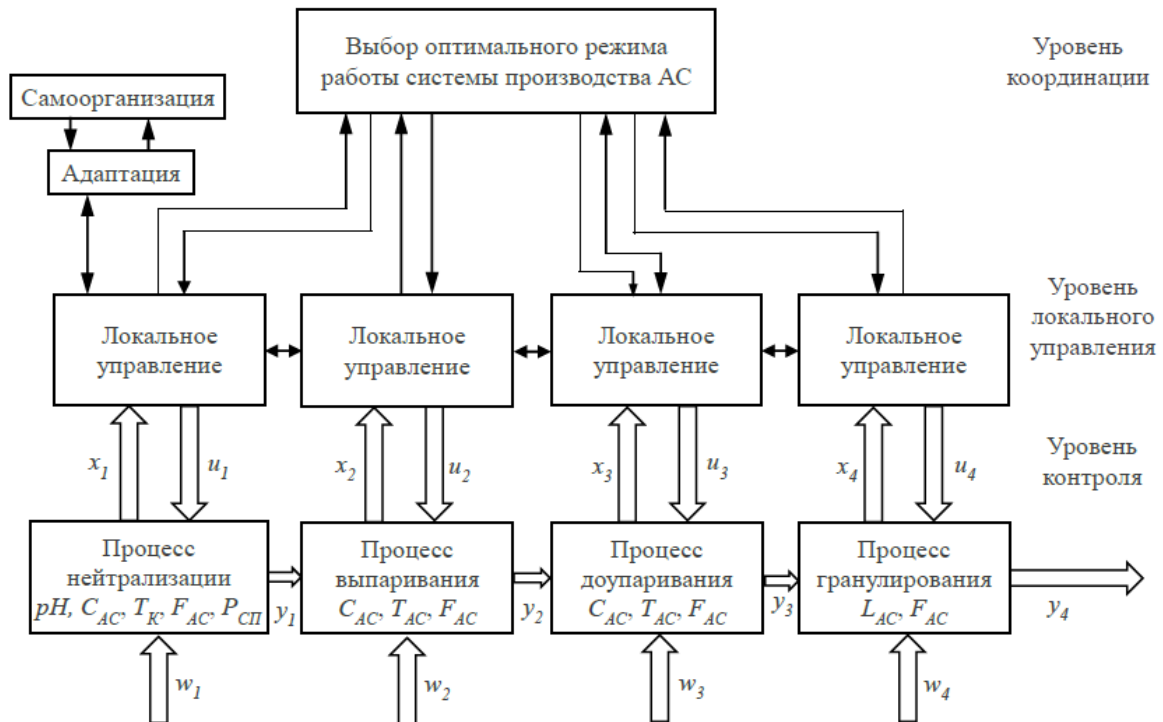
Рис. 2. Иерархическое представление системы автоматического управления процессом производства аммиачной селитры
