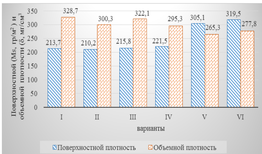
Рис. 2. Гистограмма изменения поверхностной и объемной плотности хлопко-шелковых рисунчатых трикотажных полотен
