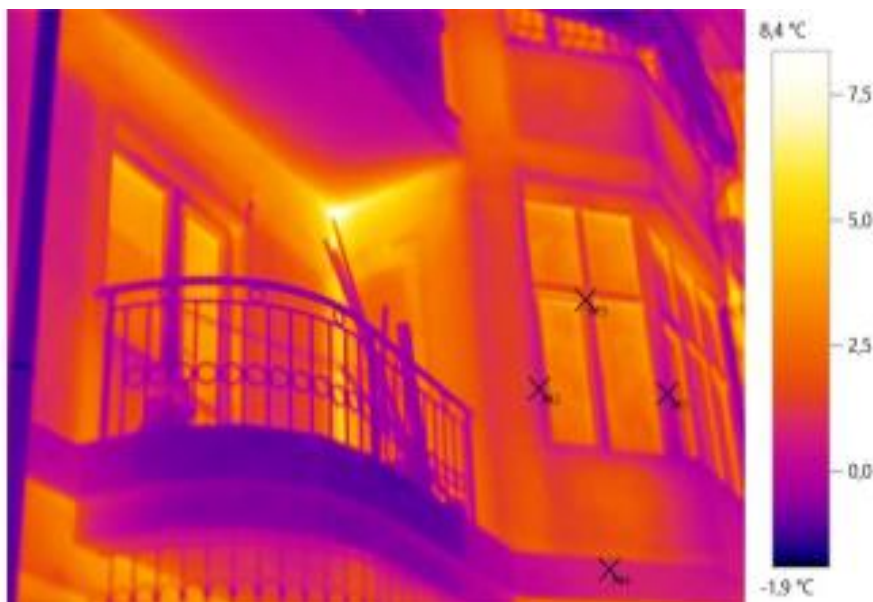
1-расм. Деворнинг балкон плитаси билан бирикиш конструкциялари туширилган фасад фрагментининг термограммаси.
