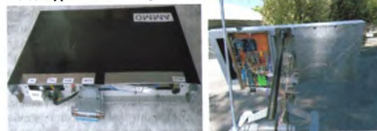
7-расм. Кўп функцияли мониторинг ва таҳислаш қурилмаси ва ўлчовлар ўтказилган иккита CIGS фотоэлектрик ўзгартиргичлари билан жиҳозланган мослама
