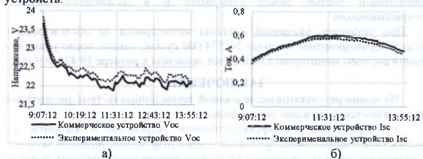
Рис. 12. Значения напряжения холостого хода (а) и тока короткого замыкания (б), полученные в течение дня с двух устройств для сравнения (25.02.2020)
