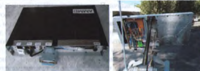
Рис. 7. Многофункциональное устройство мониторинга и диагностики, встроенное на установку с двумя фотоэлектрическими преобразователями CIGS
