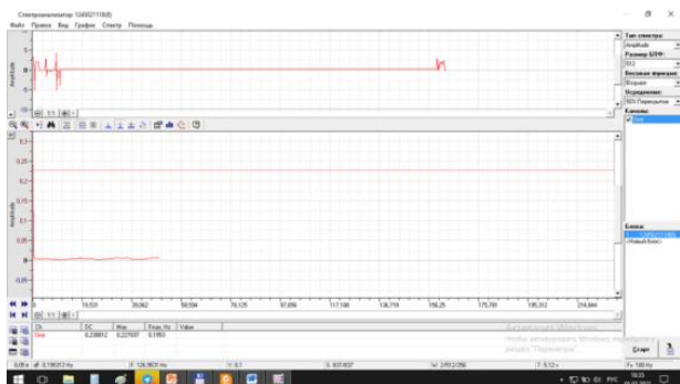
4-расм. Олинган виброакустик сигналларни Power Graph3.31 дастурида таҳлил қилиш натижаси. 40x, V = 120 м / мин, S = 0,2 мм / об / мин, t = 1 мм
