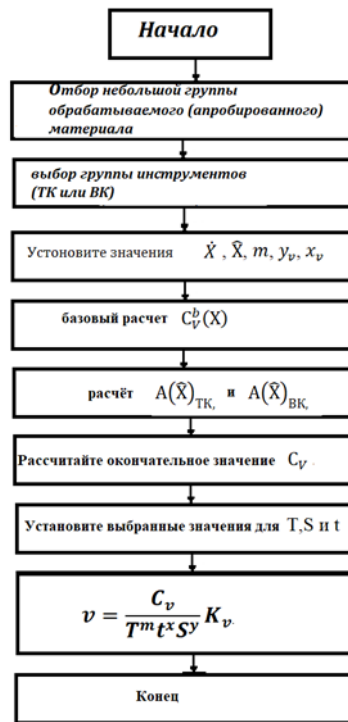
Рисунок 1 Алгоритм расчета скорости резания на основе синтезированных математических моделей
