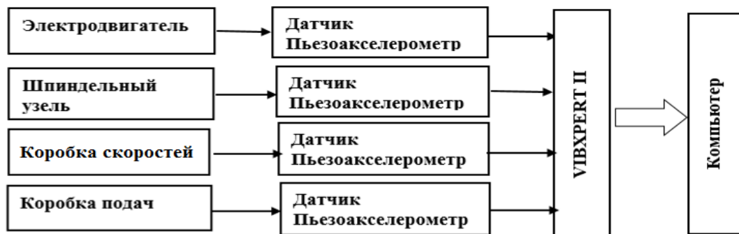
Рис. 5. Схема аппаратуры для вибромониторинга металлорежущих станков
