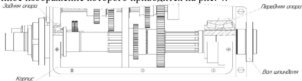
Рис. 4. Упрощенное изображение шпиндельного узла НТ-250М
