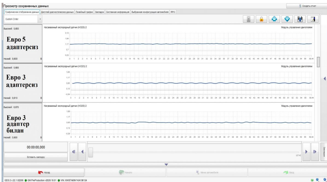
8-расм. Кислород датчиги мехатрон адаптери билан ва адптерсиз холда кислород датчиги сигналларнинг характерли қийматларини ҳар хил Евро стандартларда таққосланиши
