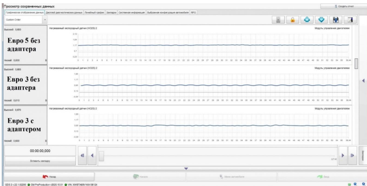
Рис. 8. Сравнения характеристики величин сигналов для управления от датчика кислорода с мехатронным адаптером кислородного датчика и без него с различными Евро стандартами
