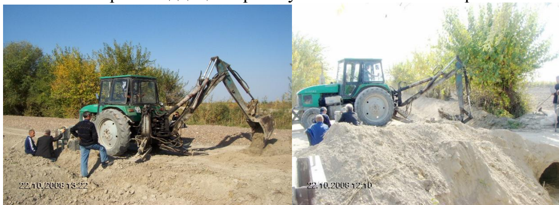
12-расм. ТТЗ-80.10 трактори базасидаги прототип машинанинг хандақ ва суғориш тармоқларини қазिश жихозлари бўйича тажриба-синов жараёни
