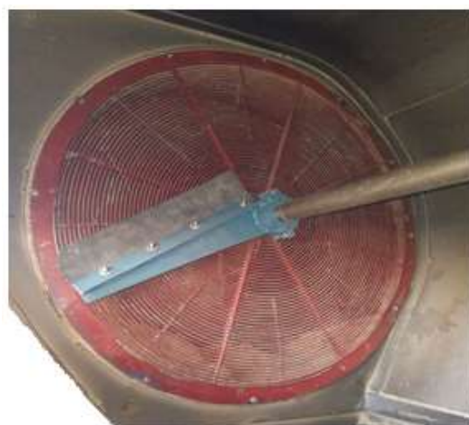
1-ҳаво камераси, 2-сидирғич, 3-вал, 4-тўрли юза, 5-ҳавони сўриш қувури 6-расм. Экспериментал сепаратор қурилмаси схемаси ва спирал тўрли сирт умумий кўриниши (ўнгда).
